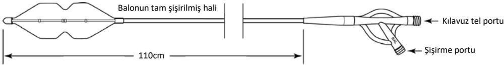
Yukarıdaki şekil yalnızca referans amaçlıdır. "BAL" olarak işaretlenmiş manifold portu balonun şişirilmesi/indirilmesi içindir. Düz manifold portu işaretlenmemiş olup, kılavuz tel geçidi olarak kullanılır.
